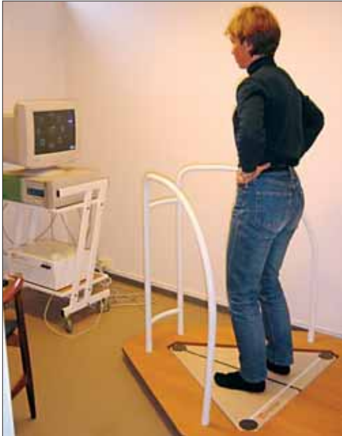
Figur 1. Den portable balanseplattformen Good Balance Metitur. Her demonstreres stående dynamisk test med skjermbilde.
