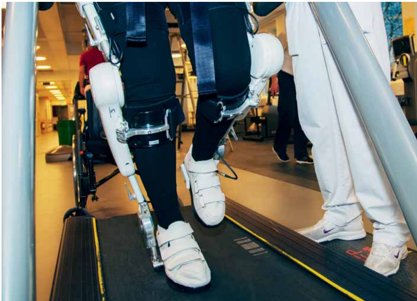
AUTOMATISK Roboten er innstilt på automatisk stilling, og styrer Mojca Legats venstre ben når hun skal ta et steg framover. Robotens bevegelse initieres når hun overfører kroppsvekten på det høyre friske benet som hun styrer selv.
